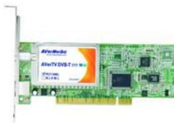
**Figura. 6.4. Tarjeta PCI televisión digital.**
