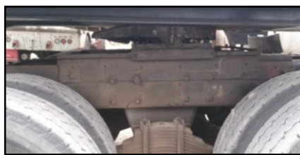
Figura 6.12. Enganche del King pin al cabezal (vista lateral)
