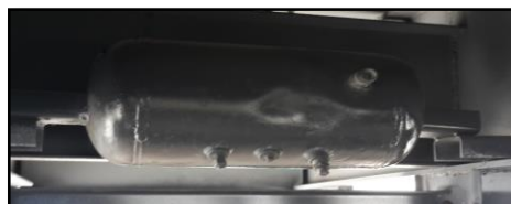
Figura 5.25. Tanque de reserva.
