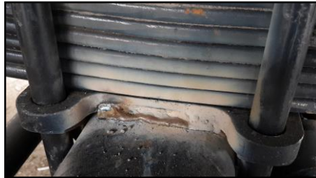
Figura 5.13. Soldadura de montura con el eje.
