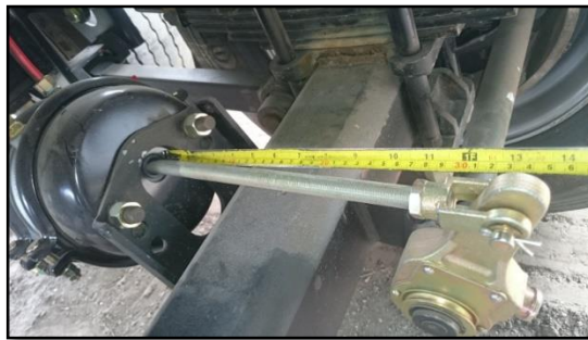
Figura 6.9. Estado del brazo en estado de presión
