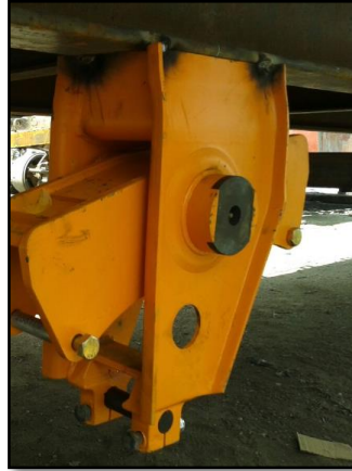
Figura 5.5. Sujeción de soporte mediante puntos de suelda.
