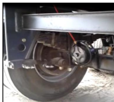
Figura 6.4. Estado de la suspensión con carga
