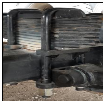
Figura 5.12. Eje sujetado a las ballestas.
