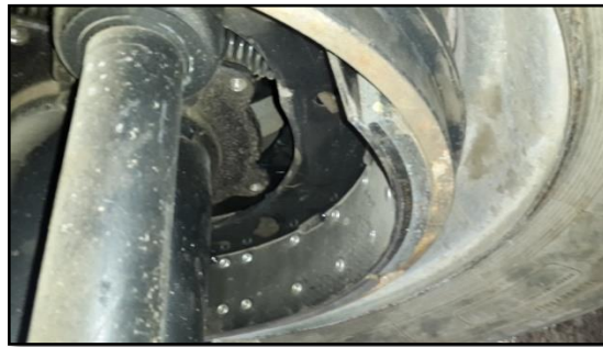
Figura 6.7. Presión de la zapata sobre el tambor de freno.
