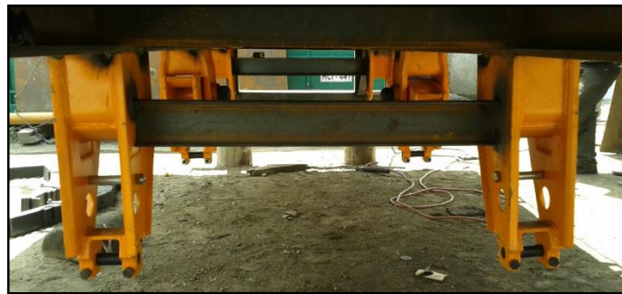
Figura 5.8. Travesaños soldados en soporte de suspensión.
