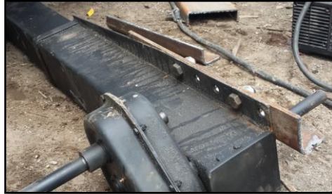
Figura 5.39. Soporte sujetado al patín de apoyo.
