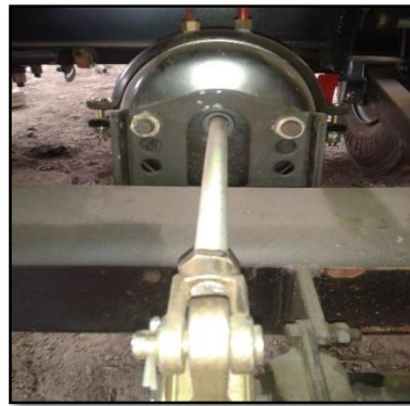
Figura 6.8. Funcionamiento del pulmón
