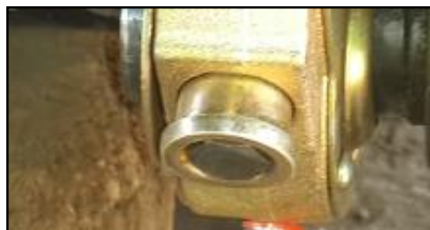
Figura 5.33. Perno de regulación de rache.
