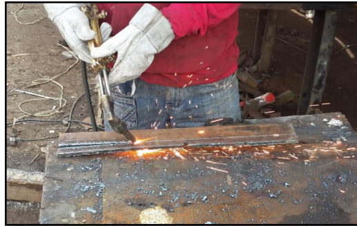
Figura 5.36. Corte de material para soportes de patines.
