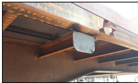
Figura 5.66. Soporte luces laterales.
