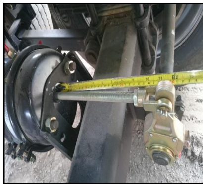
Figura 6.10. Estado del brazo en estado sin presión
