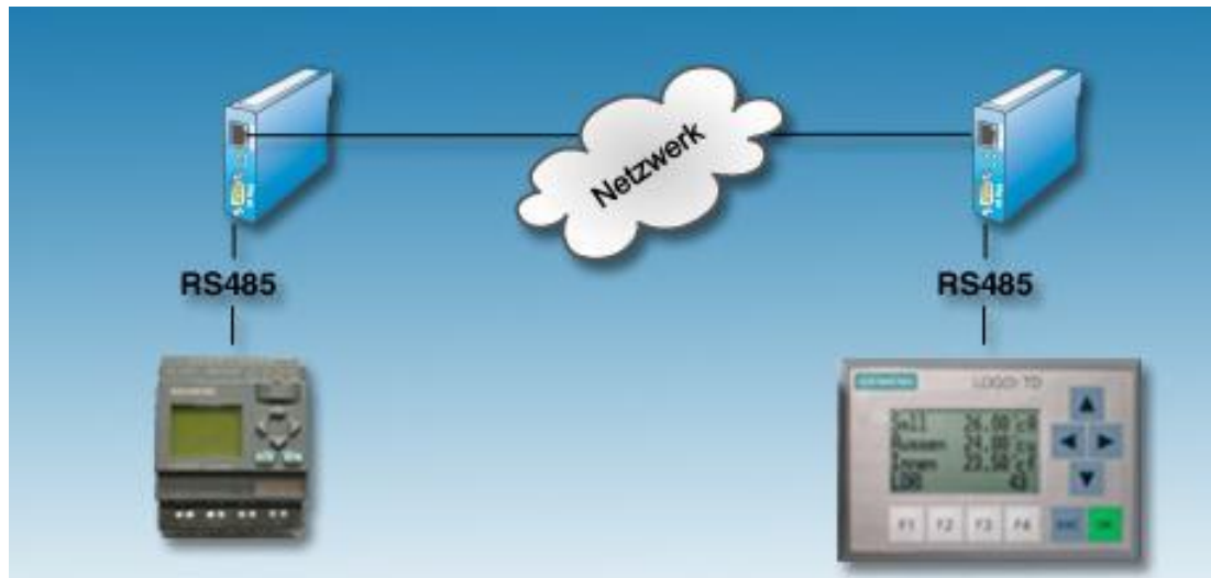
Figura 2.14. Diagrama esquemático de comunicación PLC con HMI
