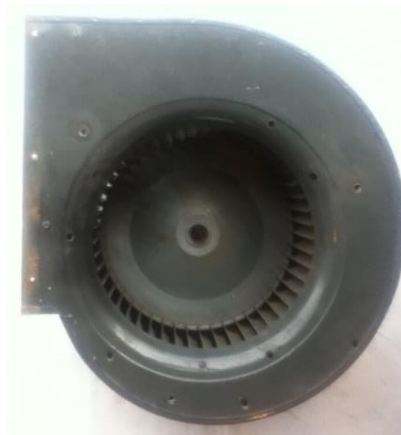
Figura 3.4. Ventilador centrífugo de álabes curvados hacia adelante
