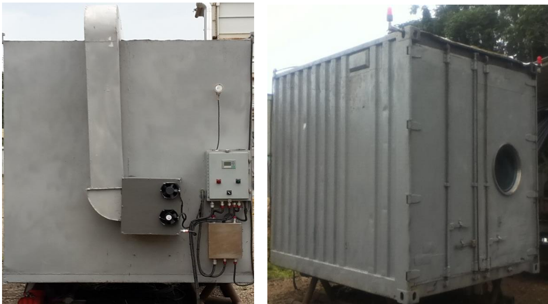
Figura 3.1. Horno para el secado de motores eléctricos
