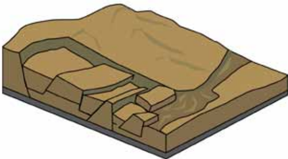
Fig. 1.74, Separación lateral. Adaptado de Varnes, 1978. GEO1-Toulkeridis
