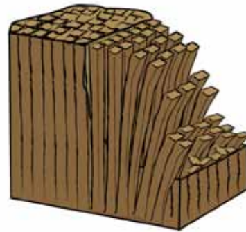
Fig. 1.79, Basculamiento de columnas de roca. Adaptado de Cruden & Varnes, 1996. GEO1-Toulkeridis
