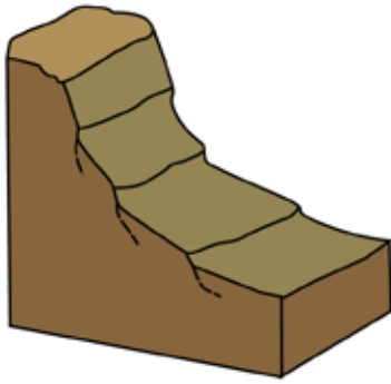
Fig. 1.76, Movimiento Sucesivo. Adaptado de Hutchinson, 1968. GEO1-Toulkeridis
