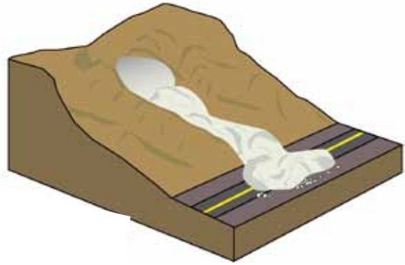
Fig. 1.71, Deslizamiento de rocas. GEO1-Toulkeridis
