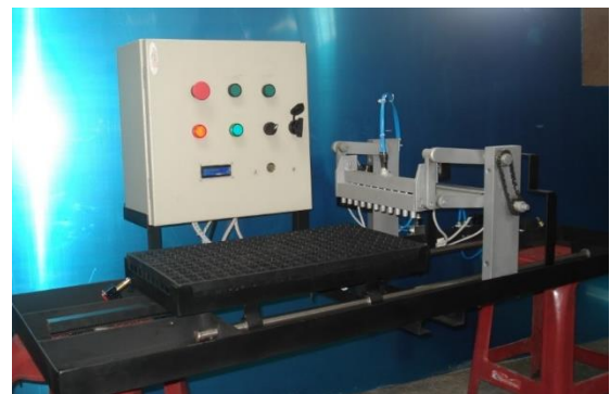
Fig. 15. Montaje del gabinete de control.
