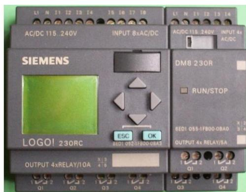
**Figura 2. 35. PLC LOGO Siemens 230RC y Módulo de expansión DM8 230R**
