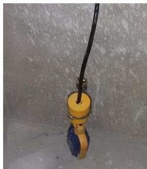
**Figura 4. 15. Pruebas de los sensores de nivel tipo boya**
