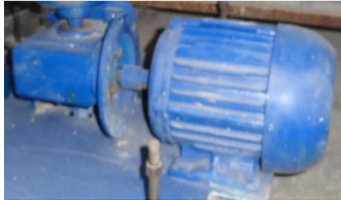
**Figura 2. 29. Motorreductor**
