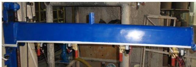
**Figura 3. 8. Montaje de las válvulas solenoides**
