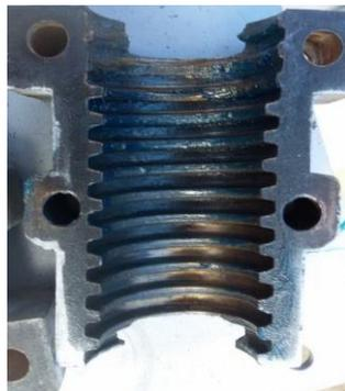
**Figura 3. 4. Montaje de la Tuerca del tornillo de potencia**
