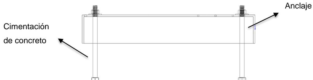
**Figura 2. 17. Placa base de soporte con perno de sujeción**
