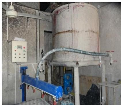
**Figura 3. 22. Distribución de la manguera de salida**
