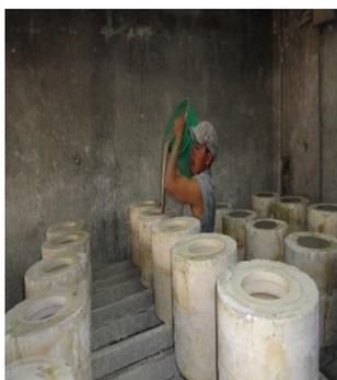
**Figura 4. 16. Vaciado de barbotina**
