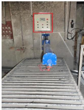
**Figura 3. 18. Tablero de control y de mando**
