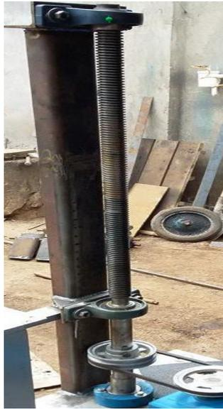
**Figura 3. 3. Montaje del tornillo de potencia**
