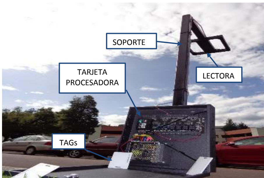
Figura 67. Prototipo armado y operando
