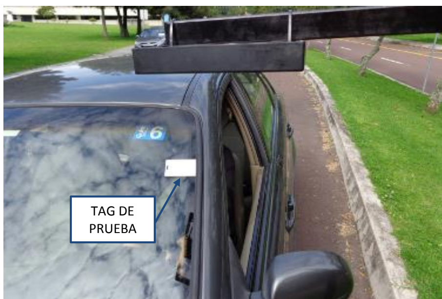
Figura 70. Ubicación Lectora – TAG Pasivo
