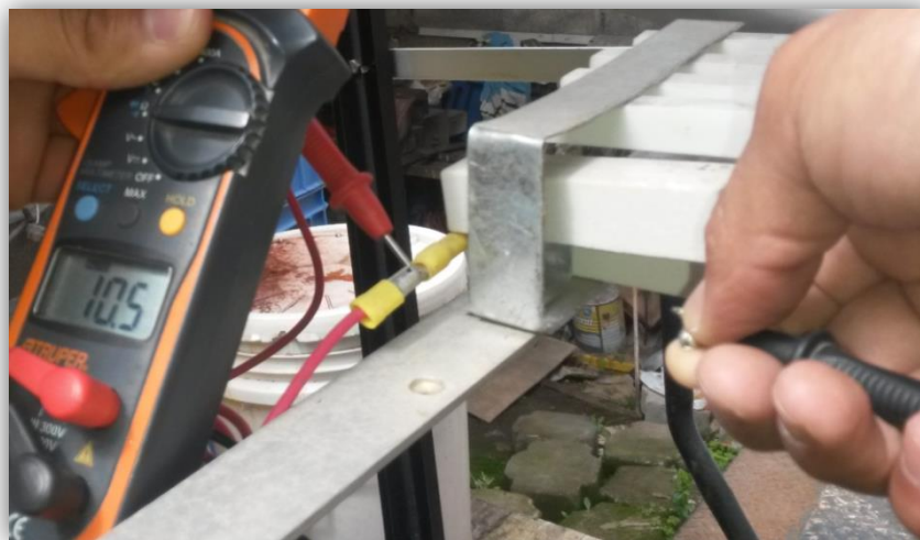
Figura 20. Resistencia R_2 real medido con un milímetro digital.
