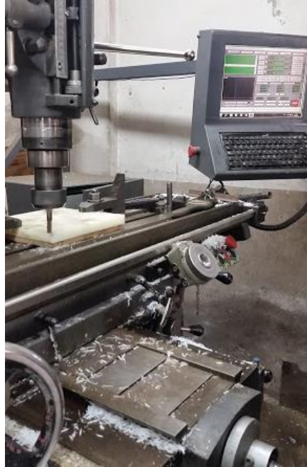
Figura 169 Maquinado de plancha de duralón
