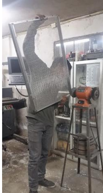
Figura 162 Pulido de aristas vivas de bandejas
