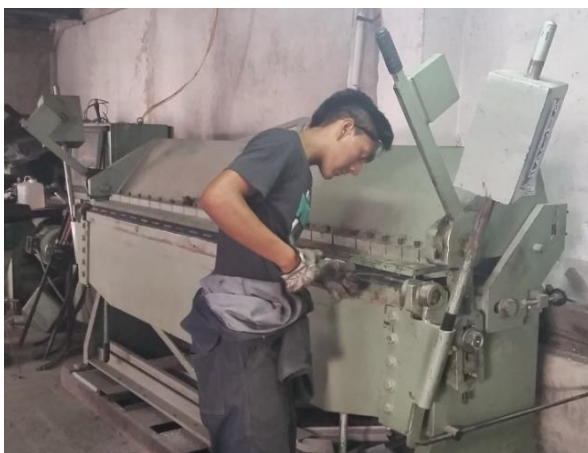
Figura 132 Doblado de las planchas de acero
