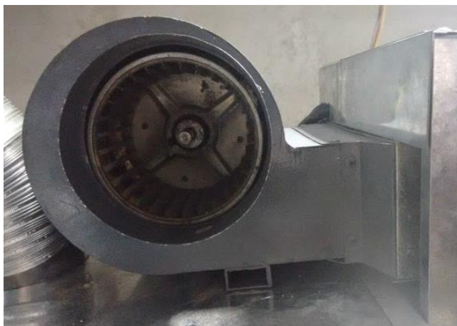
Figura 149 Ventilador Centrífugo montado
