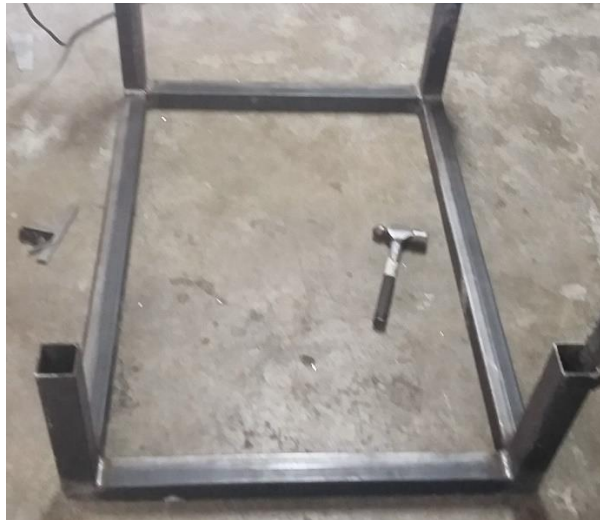
Figura 122 Estructura de soporte soldada
