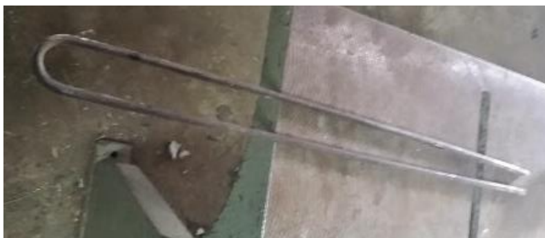
Figura 184 Resistencia eléctrica tipo U, antes del proceso de doblado
