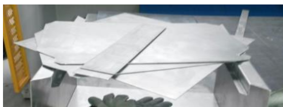
Figura 173 Secciones de la plancha de tol después de ser cortadas
