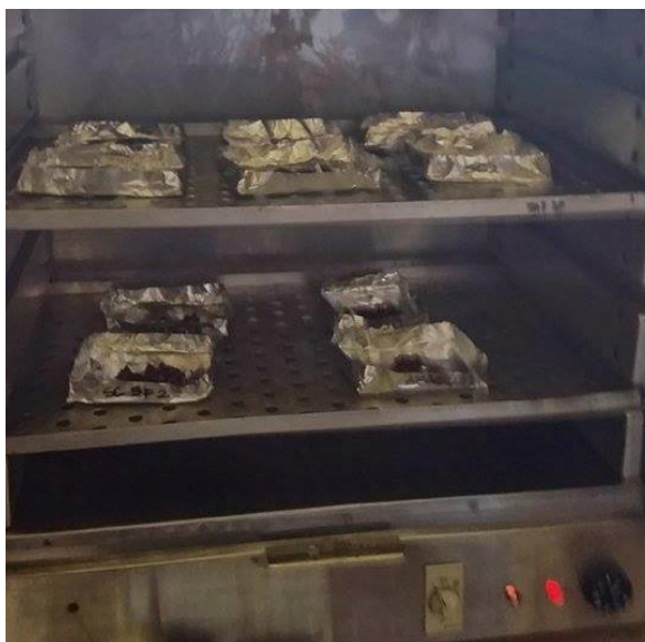
Figura 50 Muestra en la estufa a 103oC
