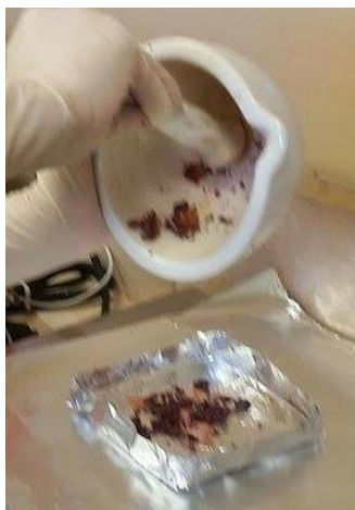
Figura 47 Colocación de la muestra en la cápsula
