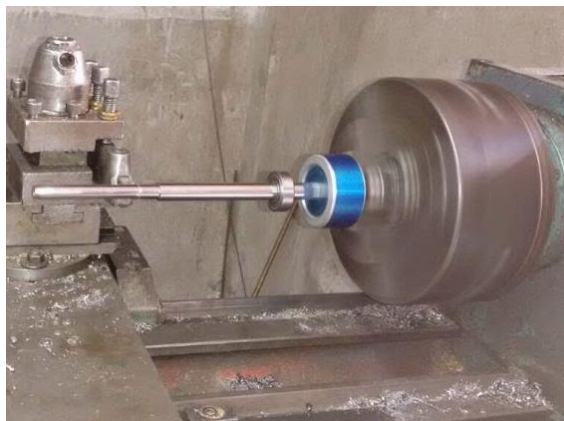
Figura 147 Torneado del eje del motor del ventilador
