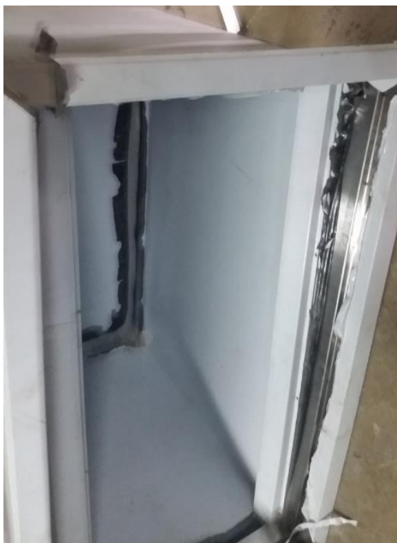
Figura 135 Cámara Interna Acero Inoxidable 304L
