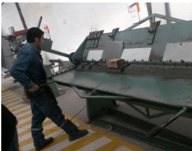
Figura 174 Proceso de doblado dl tol del gabinete de control
