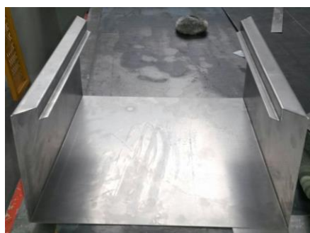
Figura 175 Resultado del doblado para la estructura principal del gabinete de control
