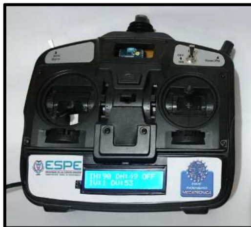
Figura 102. Control remoto implementado
