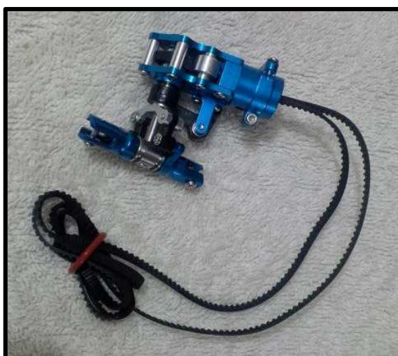
Figura 59. Mecanismo de rotor de cola con polea para transmisión de potencia
