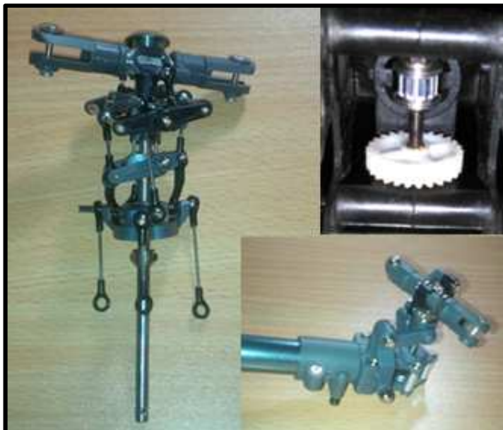
Figura 93. Rotor principal y rotor de cola – Izq.: rotor principal; Der. Superior: piñón para acople de polea; Der. Inferior: rotor de cola
