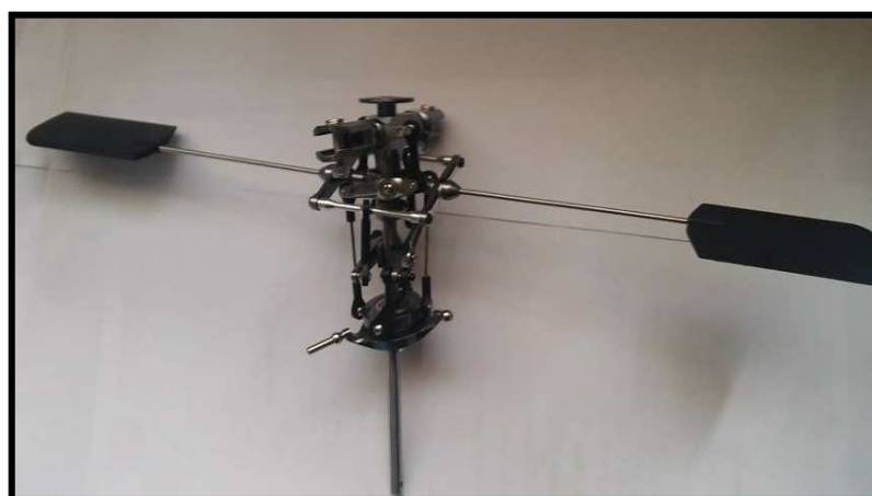
Figura 52. Plato cíclico con flybar
