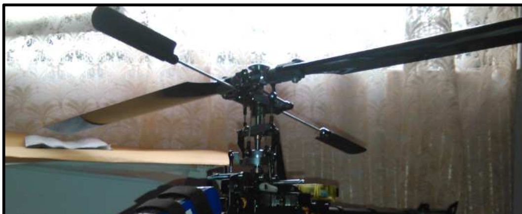
Figura 136. Pruebas de control sobre el plato cíclico
