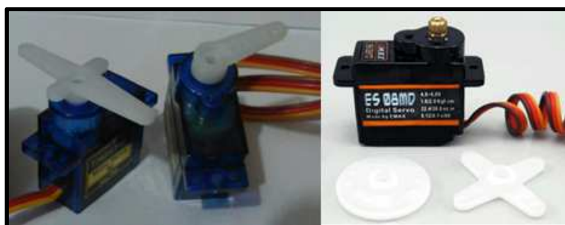
Figura 129. Pruebas de Servomotores. Izquierda: servo análogo; Derecha: servo digital
