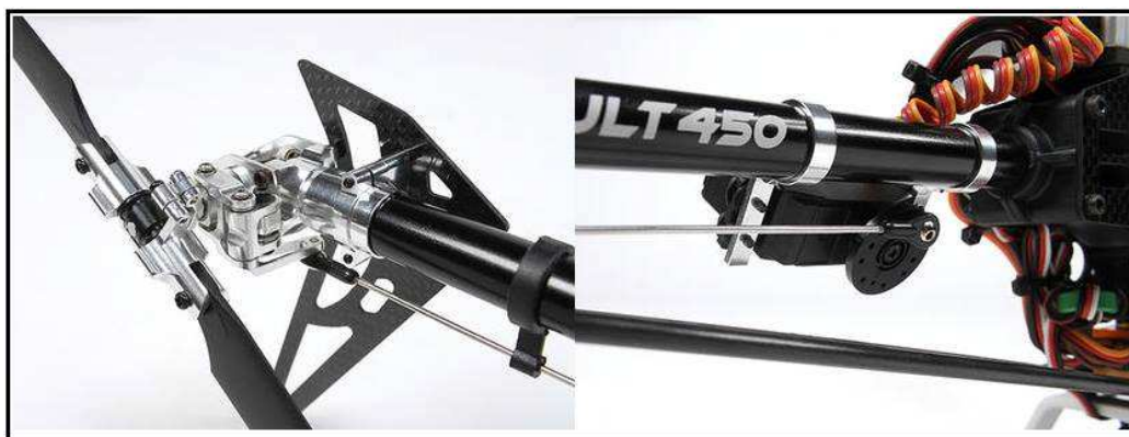
Figura 23. Rotor posterior. Izquierda: Mecanismo de rotor de cola – Derecha: servomotor para el rotor de cola
