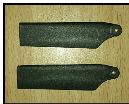
Figura 58. Palas de plástico del rotor de cola
