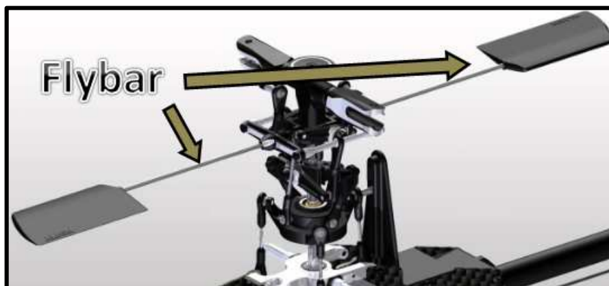
Figura 87. Flybar o barra de vuelo para el sistema de control
