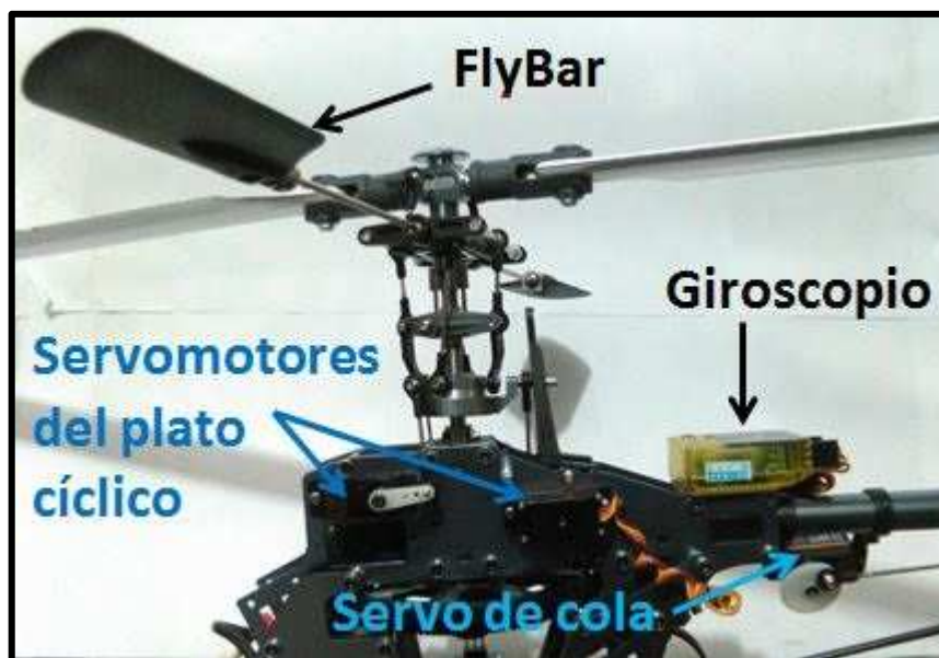
Figura 112. Elementos del sistema de control en la aeronave
