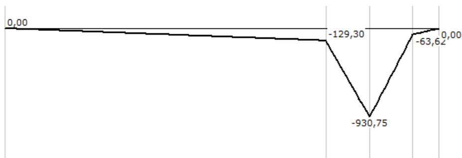
Figura 48 Diagrama de momentos flectores plano y-z
