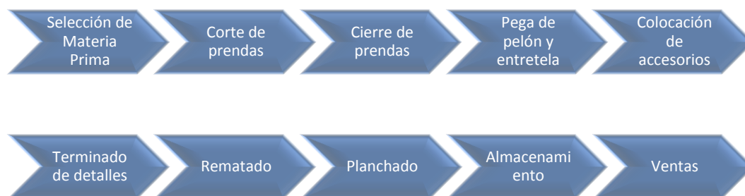
Figura 2. Proceso de producción de YAZMON
