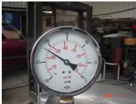
Figura 4.33. Presión de vacío Obtenida en pruebas
