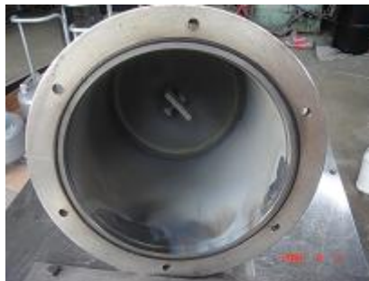
Figura 4.36. Aluminio evaporado dentro de la cámara
