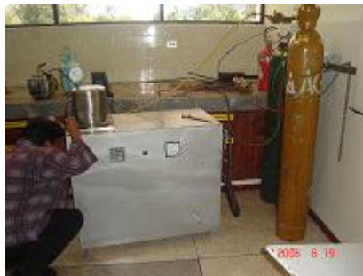
Figura 4.41. Inyección de Nitrógeno dentro de la cámara montada
