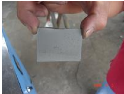
Figura 4.39. Sustrato recubierto de aluminio
