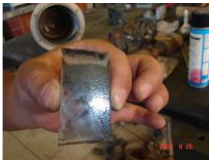
Figura 4.44. Pequeña cantidad de metalizado sobre el sustrato
