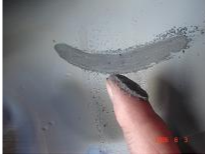
Figura 4.37. Espesor capa de aluminio evaporada
