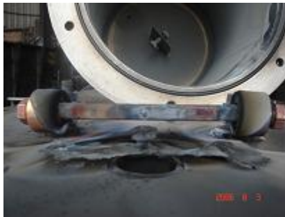
Figura 4.38. Formación de costras de aluminio en la placa base
