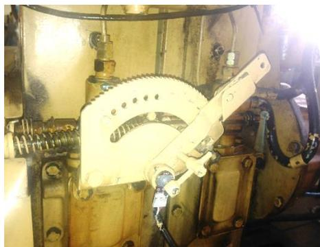
Figura 99 Acoplamiento del potenciómetro al acelerador manual
