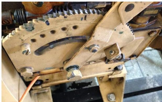
Figura 65 Acelerador manual
