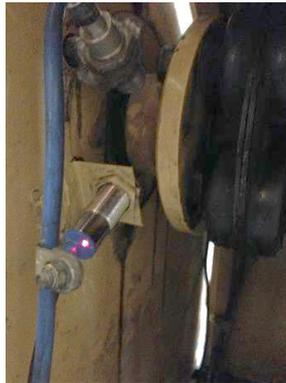
Figura 96 Instalación sensor inductivo al eje del motor
