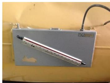
Figura 73 Manómetro inclinado TYPE 504
