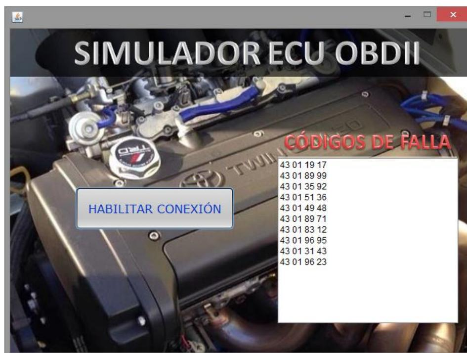
Figura. 4.4 Simulador generador de códigos de falla
