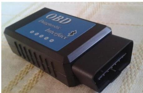
**Figura. 2.5 Adaptador BAFX OBDII**
