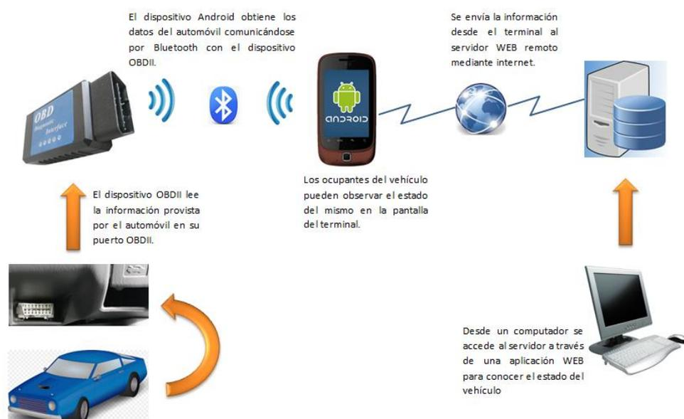
**Figura. 1.1** Esquema del sistema de monitoreo automotriz
