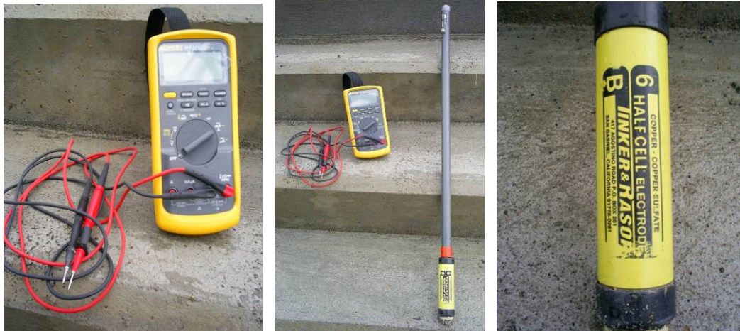
Figura 2.16 Electrodo de Cobre/Sulfato de cobre y Multímetro
