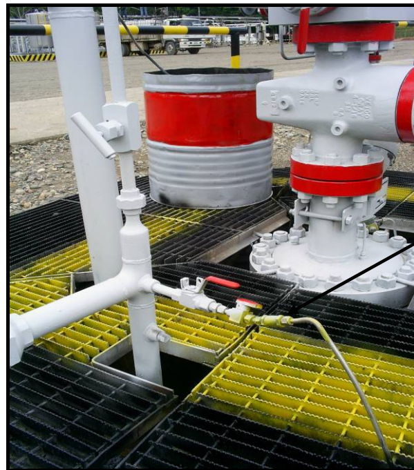
Figura 2.3 Cabezal de Extracción de Crudo – Inyección del químico a la recirculación.
