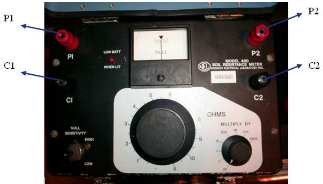
Figura 3.50 Conexiones del medidor de resistividad Donde P1, P2, C1, C2 son los puntos de conexión.
