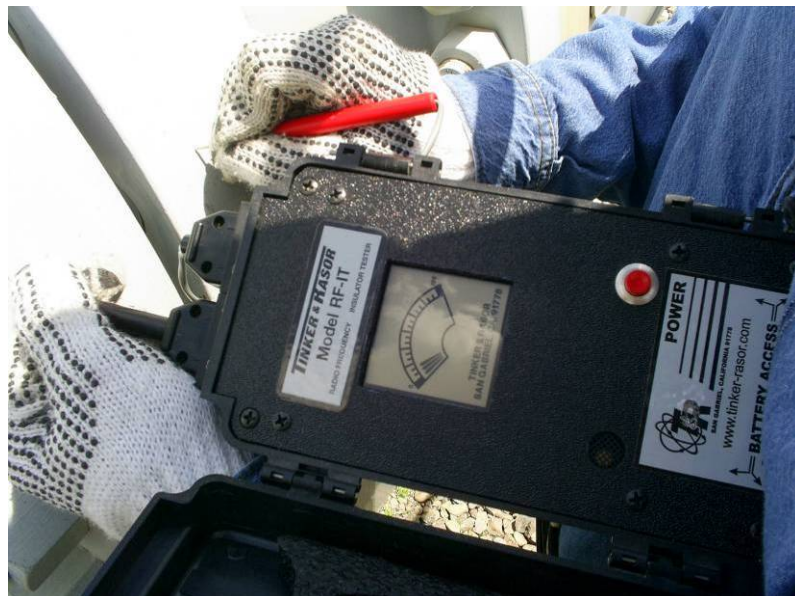
Figura 3.44 Medidor de eficiencia de juntas aislantes Tinker & Rasor Model RF-IT
