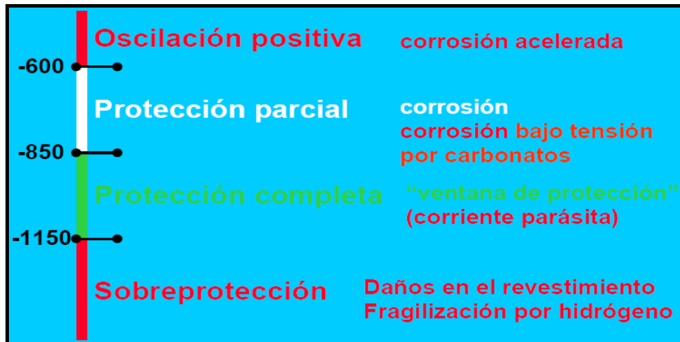
Figura 3.32 Efectos perjudiciales de la protección catódica
