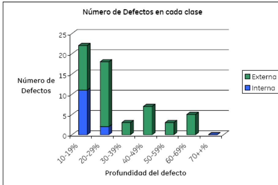
Figura 2.47 Defectos tubería La Y a IRO A Febrero 16, 2006
