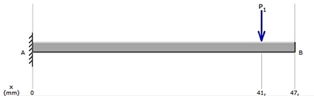
Figura 49 Diagrama de cuerpo libre falange proximal
