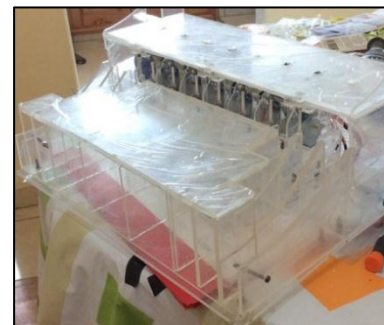
Figura 14 Estructura teclado y línea Braille
