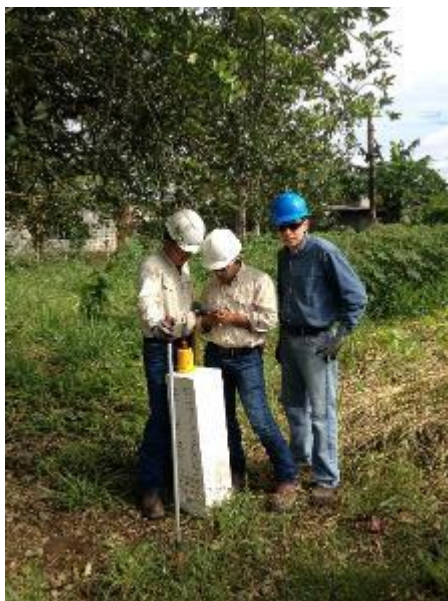
Figura 71: Medición de Potenciales Poste a Poste.
