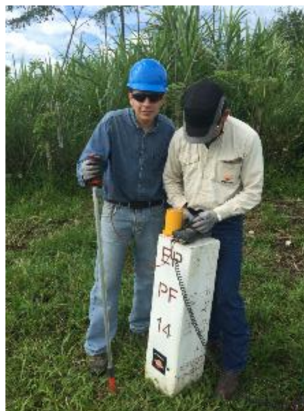
Figura 71: Medición de Potenciales Poste a Poste.
