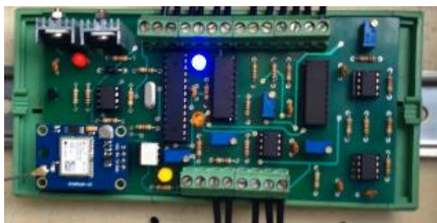
Figura 48: Circuito de Acondicionamiento y Sincronización.
