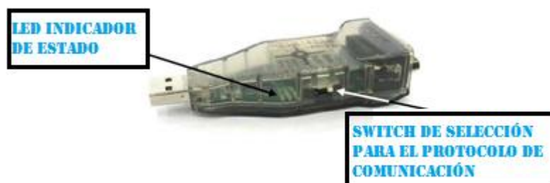
Figura 46: Switch de selección para el protocolo de comunicación del USB2Dynamixel
