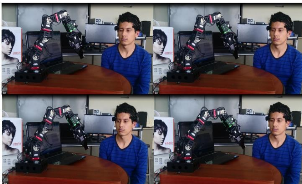
Figura 98: Movimiento que realiza el brazo robótico hacia adelante a través de un guiño del ojo derecho
