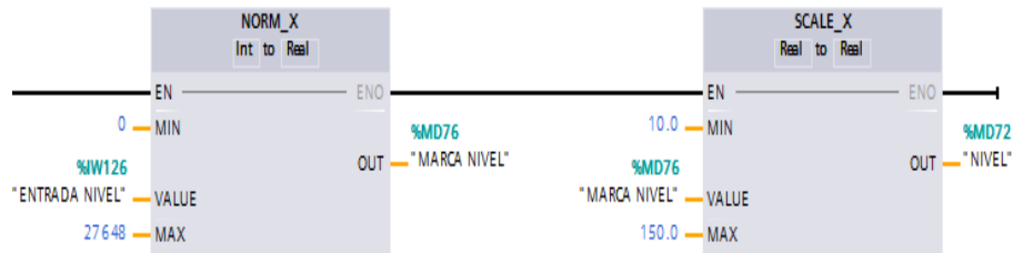
FIGURA Nº 38 Bloque NORM_X y SCALE_X para Nivel
