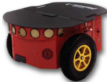
Figura 3. Plataforma móvil Pioneer P3-DX
