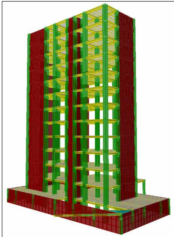
**Figura 47.-** *Modelo matemático del Edificio de 12 pisos.*
