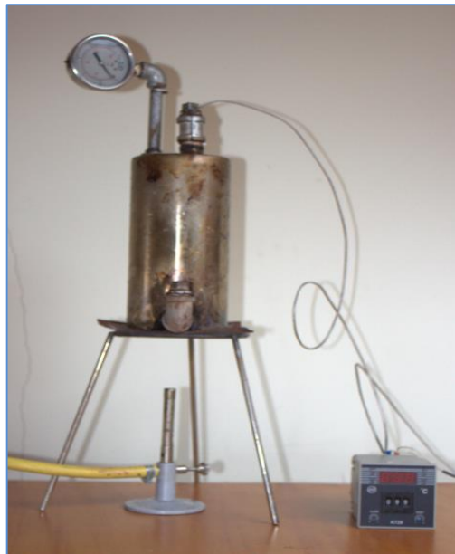
Figura 37. Equipo construido para el calentamiento de aceite.
