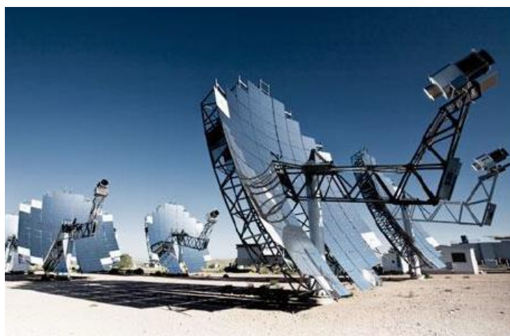
Figura 5. Concentrador Tipo Disco Parabólico.
