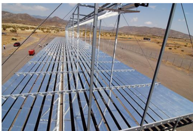
Figura 3. Colector demostración Fresnel lineal MAN, en la plataforma Solar de Almería (PSA).
