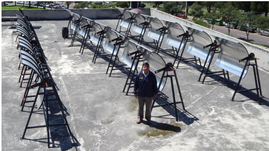
Figura 56. Prototipo de central termo solar, ubicado en la terraza del laboratorio de energías renovables de la ESPE – Sangolquí.
