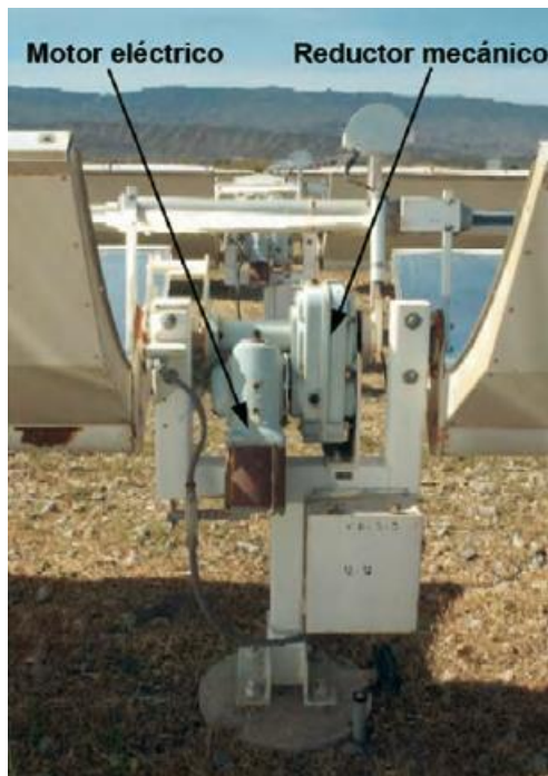
Figura 10 a. Motor eléctrico con reductor
