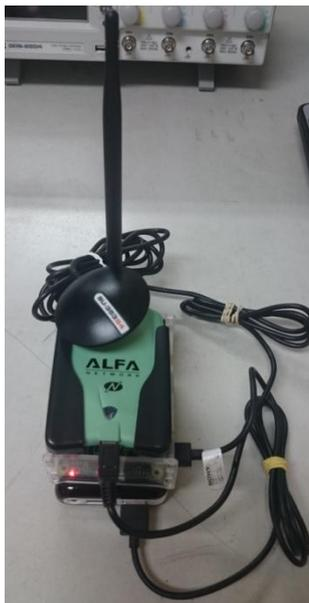
**Foto 2.** Prototipo de Sistema de Análisis de tráfico de redes 802.11
