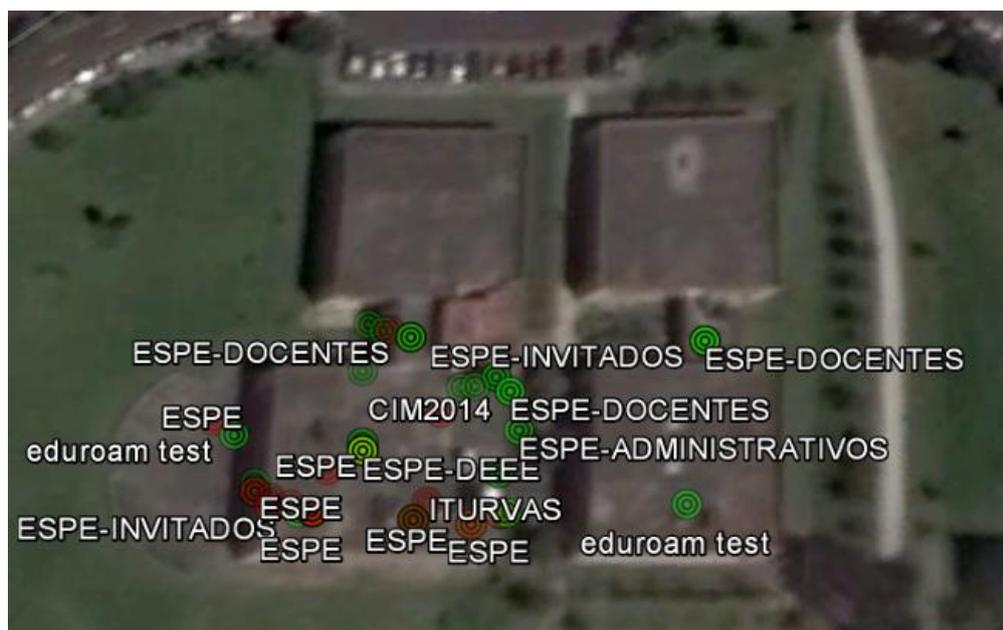
**Figura 86.** Georeferenciación de AP mediante GisKismet
