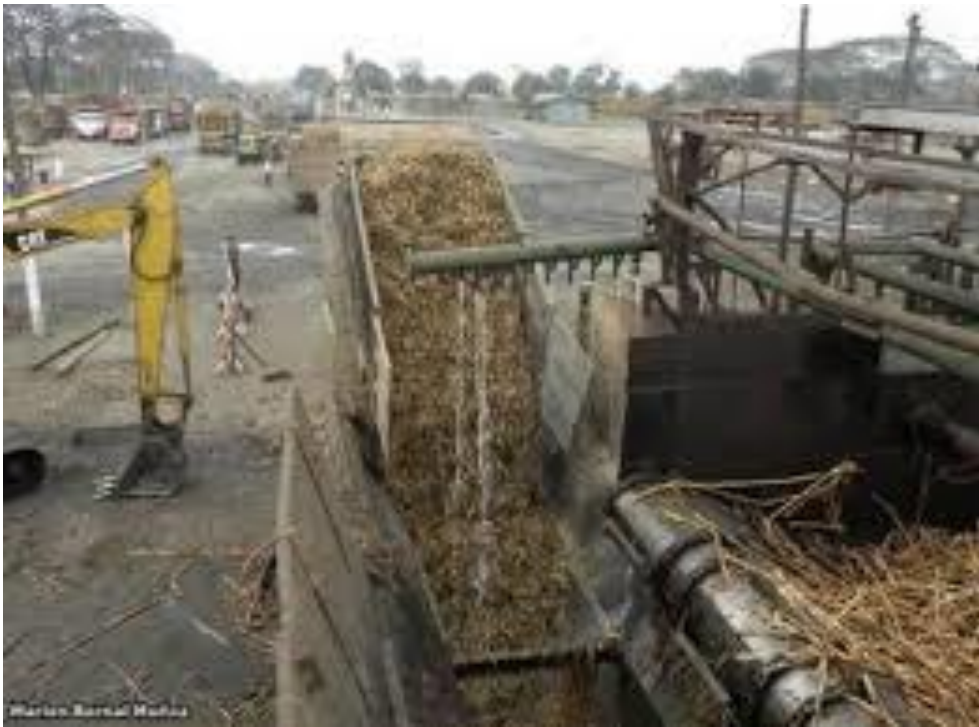
Figura 14. Trituración de la caña y obtención del bagazo.
