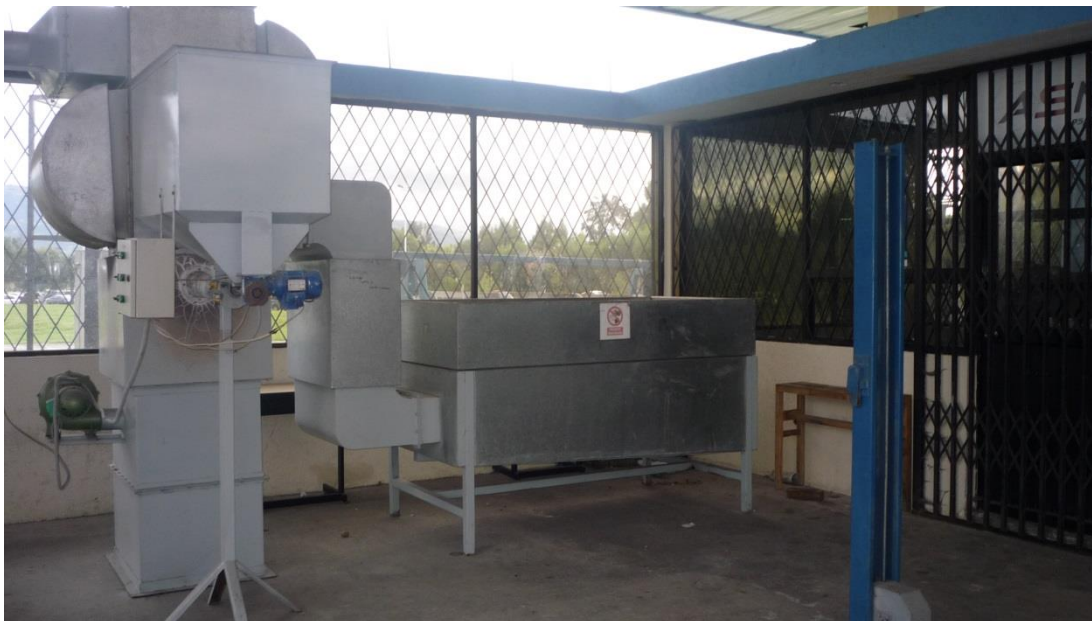
Figura 2. Secador de Madera con Cámara de Combustión de Biomasa
