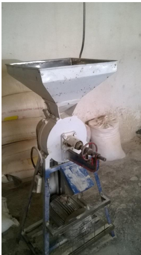
Figura 35. Molino harinero utilizado para pulverizar la tusa
