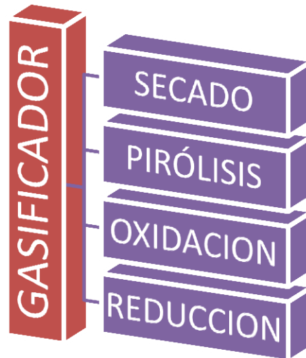
Figura 25. Procesos termoquímicos de un gasificador
