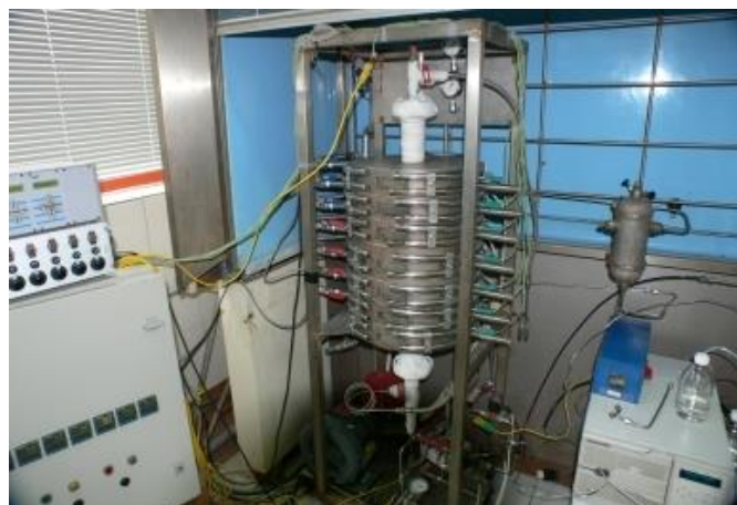
Figura 19. Sistema de combustión catalítico.
