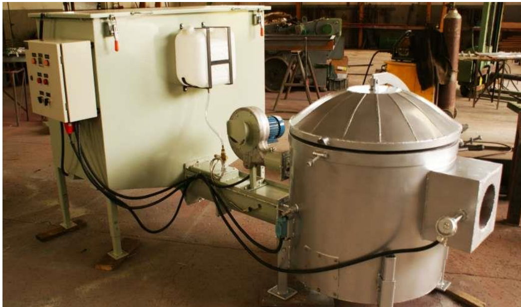
Figura 17. Sistema de alta temperatura para secado de biomasa.
