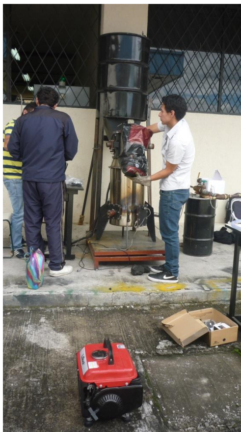
Figura 3. Gasificador tipo downdraft con motor de combustión interna
