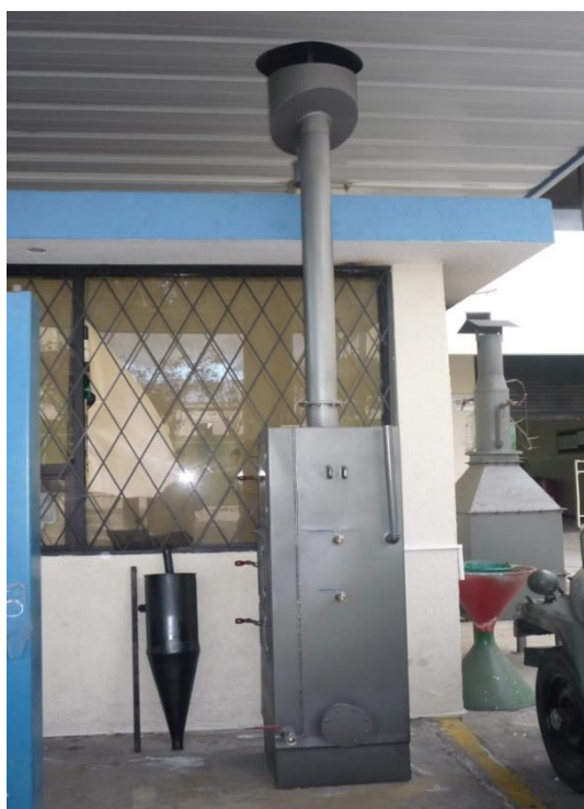
Figura 5. Cocina eficiente de tiro natural y calentador de agua
