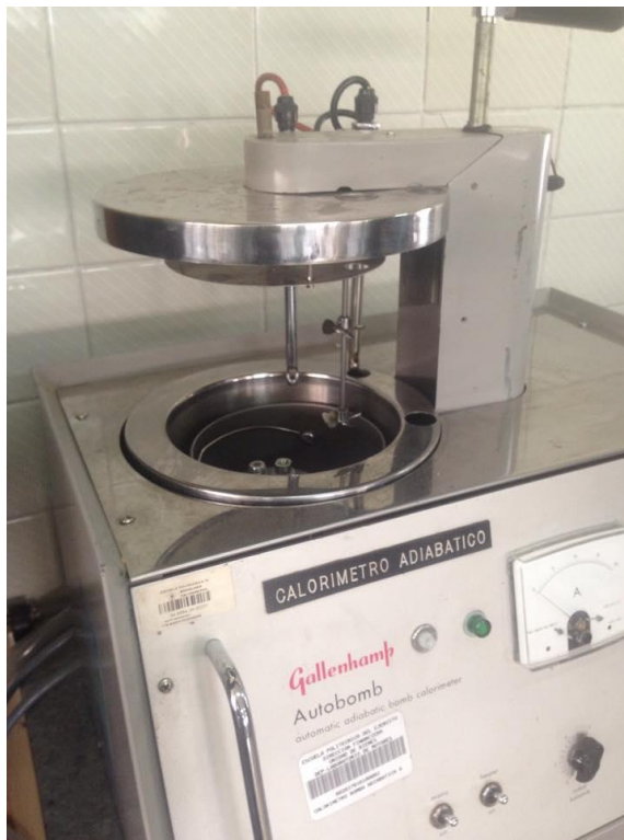
Figura 43. Bomba calorimétrica, componentes internos
