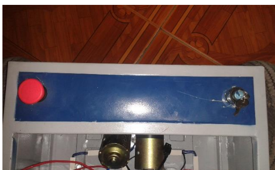
Figura 46. Paro de emergencia y switch de encendido
