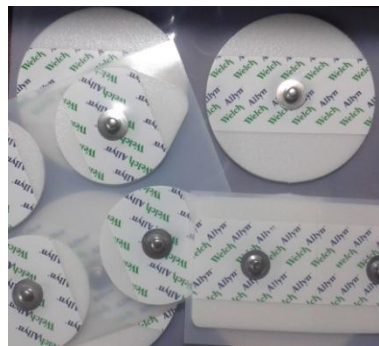
Figura 37. Electrodo de superficie de Ag/AgCl utilizados en el prototipo.
