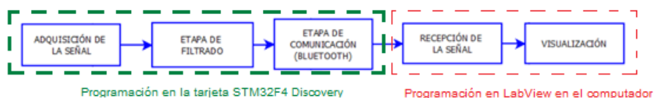
Figura 4. Diagrama de bloques del software del prototipo.
