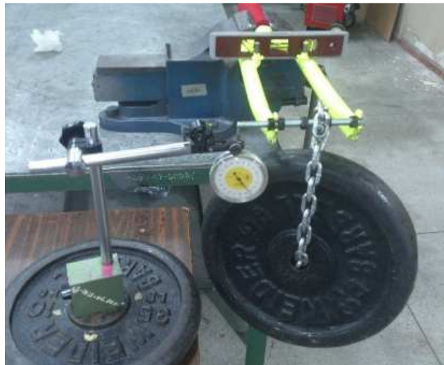
Figura 26. Determinación experimental deformación estática en horquilla.
