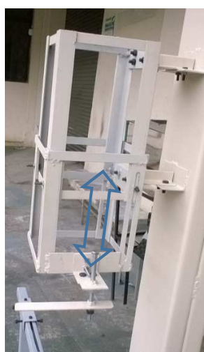
Figura 94. Extensión máxima de la guía móvil del sistema 8.
