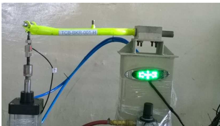
Figura 105. Antes de los 50000 ciclos (muestra TCB-BKR-001-H).
