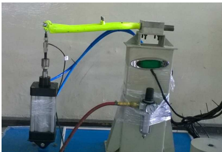
Figura 106. Después de 50000 ciclos, muestra TCB-BKR-001-H deformada.
