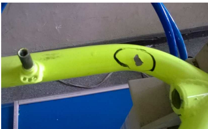
Figura 107. Falla de adherencia en el recubrimiento, fatiga
