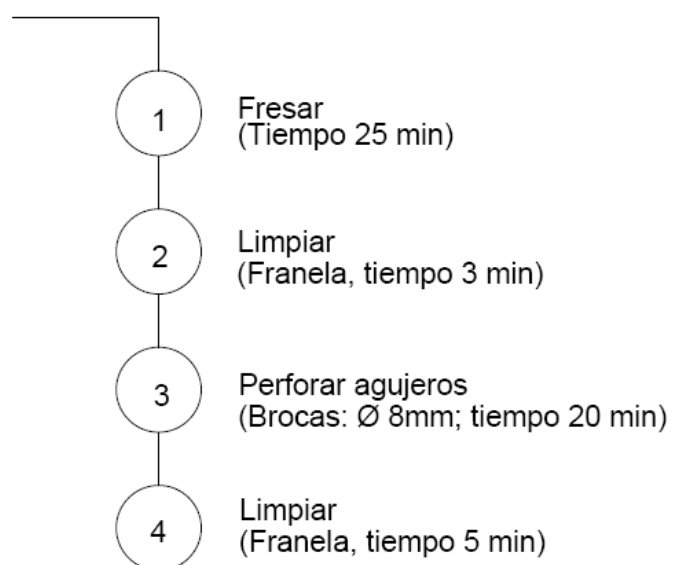
Figura 101. Diagrama de proceso de alojamiento horquilla inferior
