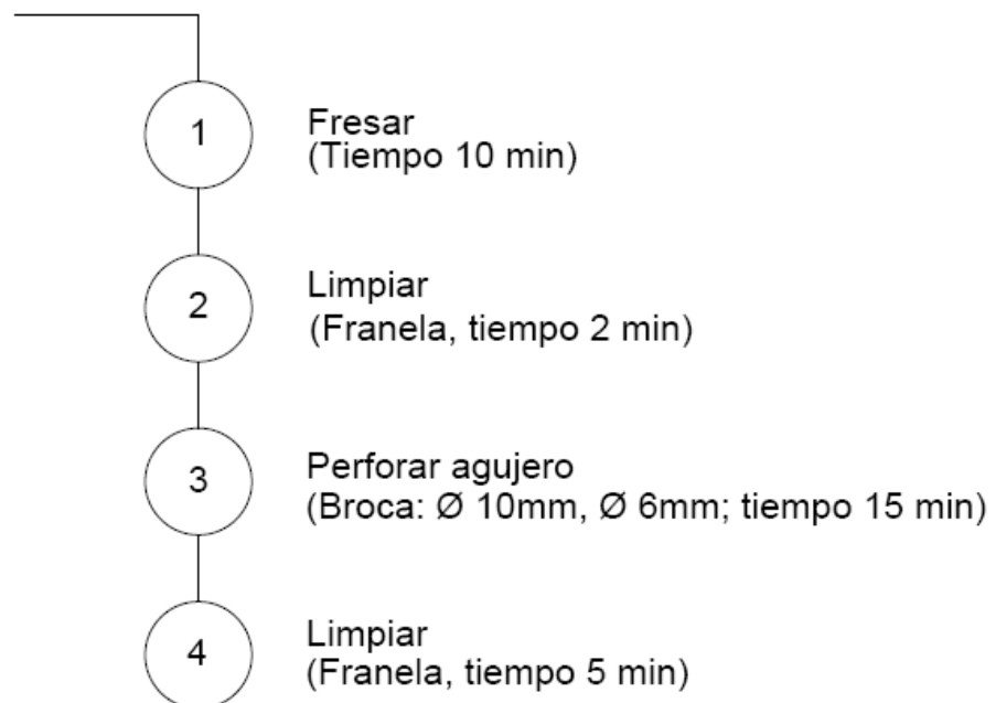
Figura 83. Diagrama de procesos del soporte del variador
