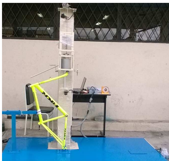
Figura 98. Muestra TCB-BKR-001 impactada
