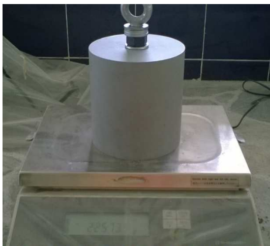
Figura 89. Pesaje de la masa m1
