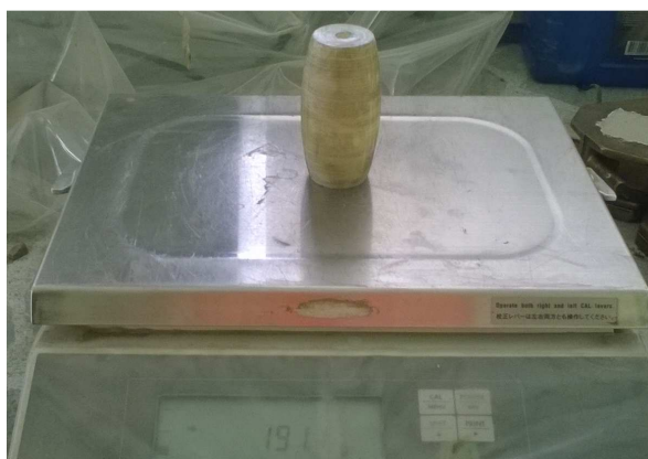
Figura 90. Pesaje de la masa rodante.
