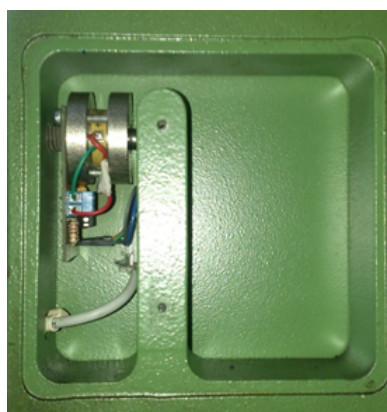
Figura 4.31: Sensor Piezoeléctrico ubicado
