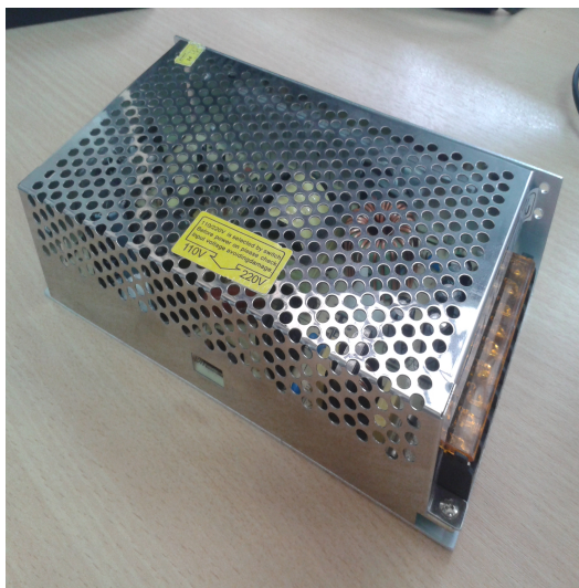
Figura 4.7: Fuente Conmutada 12V - 250W
