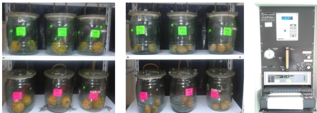
Figura 13. Sistema cerrado para medición de respiración y analizador de gases.
