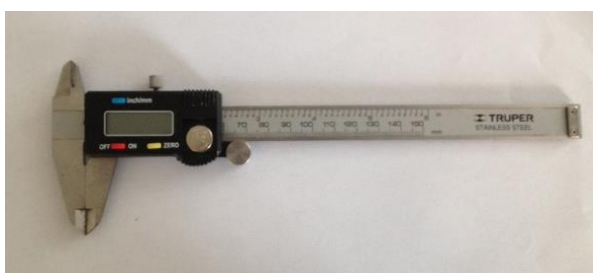
Figura 8. Pie de rey para medir la longitud y calibre.
