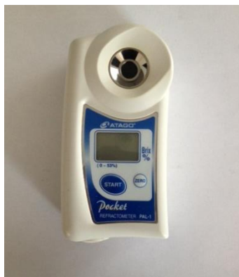
Figura 12. Refractómetro utilizado para medir los sólidos solubles.
