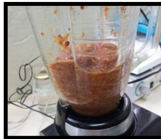
Figura 11. Primer pre-tratamiento de cascarilla de arroz y zuro. a. Molienda de los residuos. b. Cascarilla de arroz molido. c. Zuro molido
