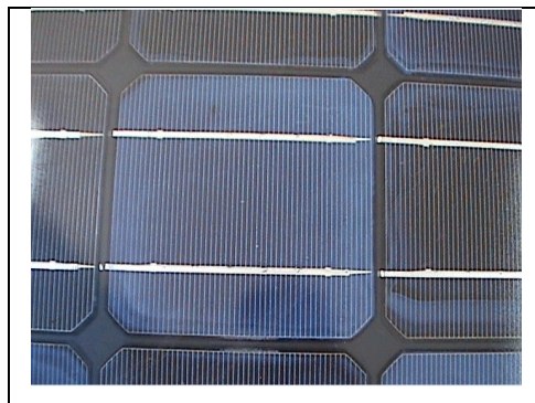
Figura 6 Panel fotovoltaico con células de silicio mono cristalino
