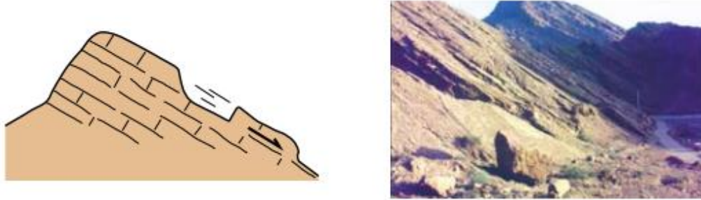
Figura 5. Deslizamiento Traslacional Fuente: (GEMMA, 2007)
