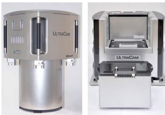
Figura 2.11 Unidad del sensor (izquierda) y el sistema de almacenamiento a bordo (derecha), componentes de la Ultracam XP Fuente: (Gruber & Wiechert, 2009)
