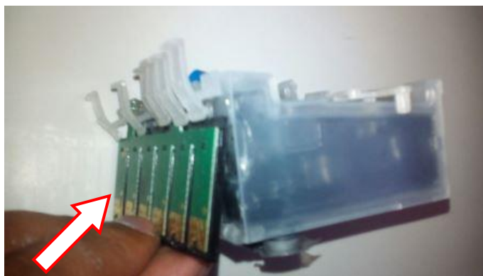
Figura 62: Instalación del chip de sistema continuo de tinta.
