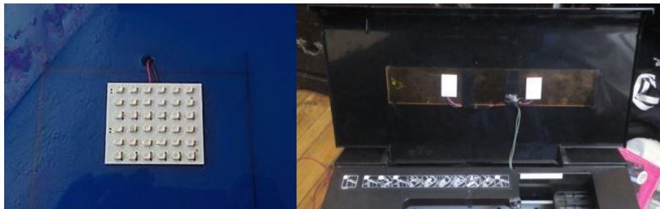
Figura 59: Iluminación led UV, izquierda en módulo de curado y derecha en la cubierta de la impresora.
