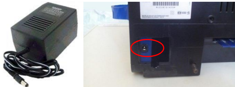
Figura 60: Alimentación panel led, izquierda fuente de alimentación 110v/120v- 12v y derecha conector hembra 12v en impresora.
