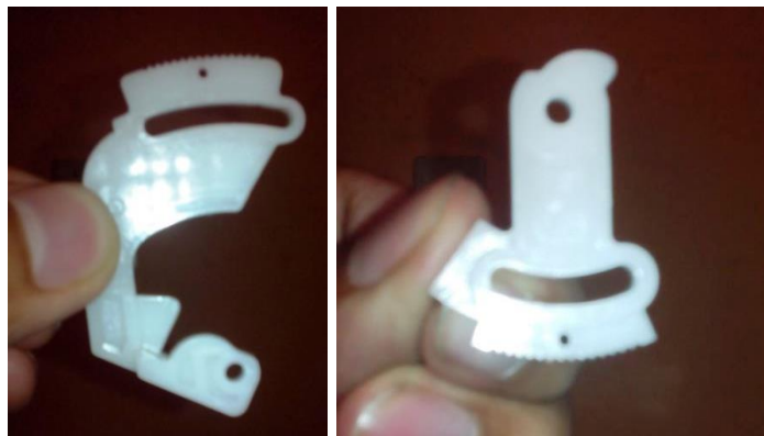
Figura 11: Soportes originales del eje que guía el cabezal de impresión.
