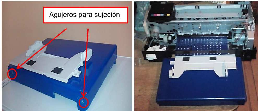
Figura 50: Resultado definitivo Módulo soporte de alimentación
