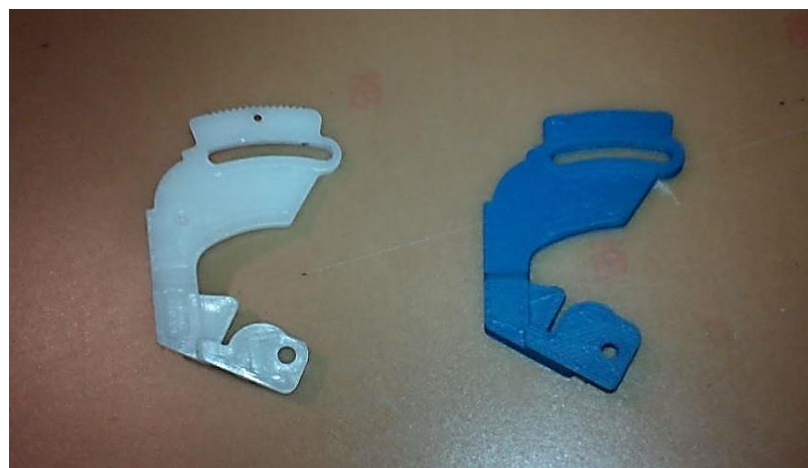
Figura 56: Resultado definitivo soporte derecho: izquierda antiguo soporte, derecha nuevo soporte
