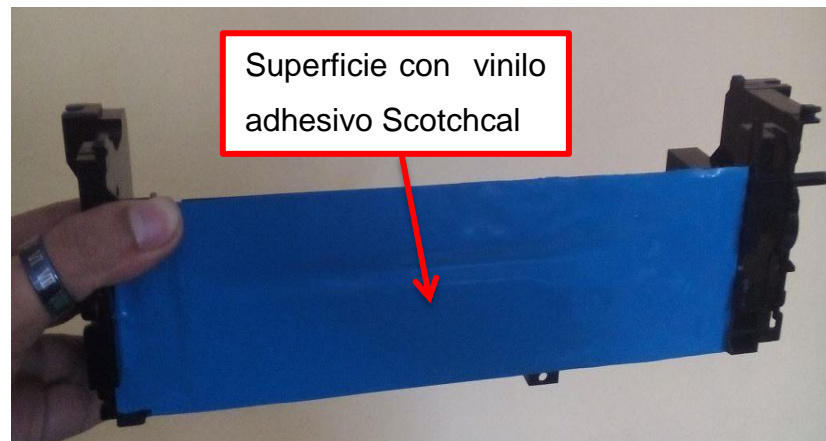
Figura 17: Epson Base del ASF ASSY con vinilo autoadhesivo Scotchcal.
