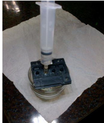
Figura 61: Limpieza del cabezal de impresión.
