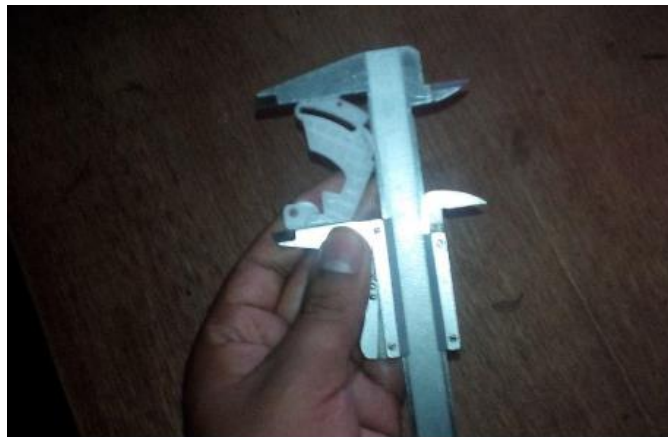
Figura 31: Medición del soporte izquierdo con calibrador pie de rey
