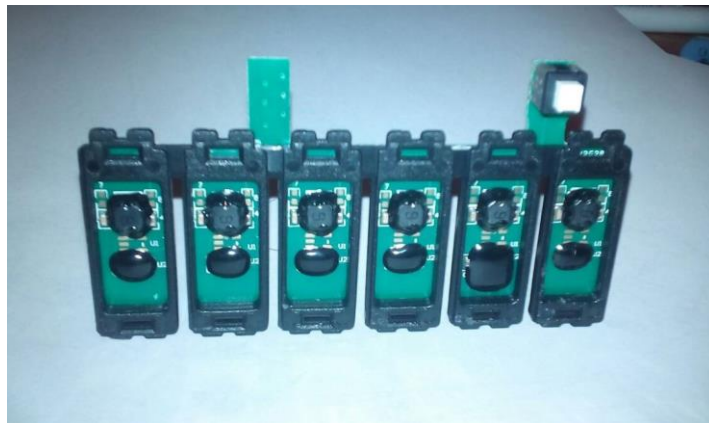
Figura 42: Chip Epson T50 para sistema de continuo de tinta.
