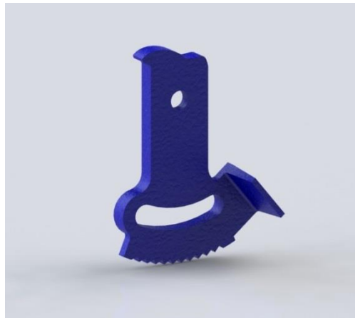
Figura 53: Diseño concluyente en SolidWorks del soporte izquierdo
