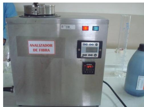
**Fotografía N° 25 y 26 Análisis de Fibra en el analizador de fibra y lavado con acetona**
