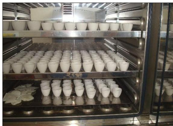
Fotografía N° 16. Muestra en la estufa a 65°C por 48 horas para determinar MS
