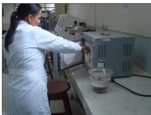
Fotografía N° 17. Determinación ceniza en horno Mufla
