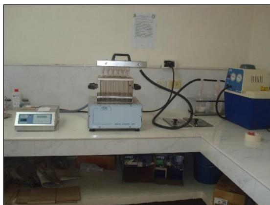
**Fotografía N° 19. Digestor y bomba al vacío**
