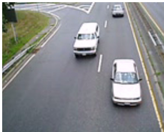
Figura 27: Vista superior desde 4.50 metros de altura, ideal para detección vehicular.
