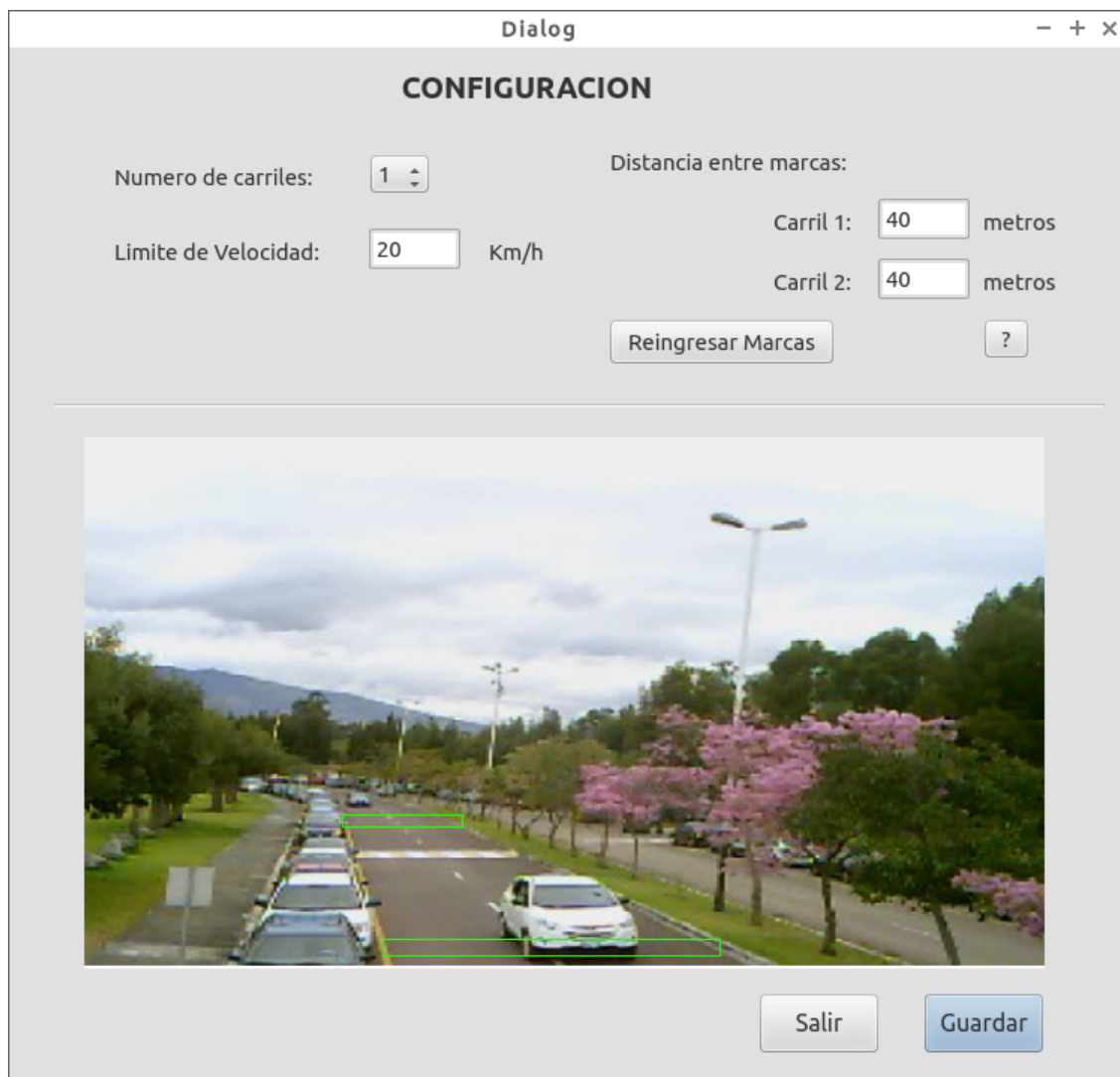
Figura 64: Configuración inicial para las pruebas de funcionamiento.
