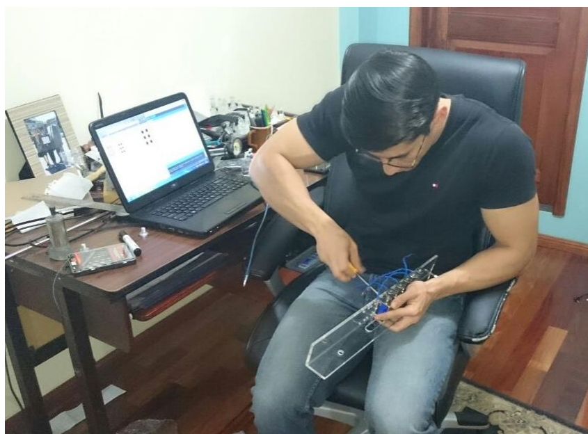
Figura 61: Sujeción de los actuadores a la placa superior de acrílico
