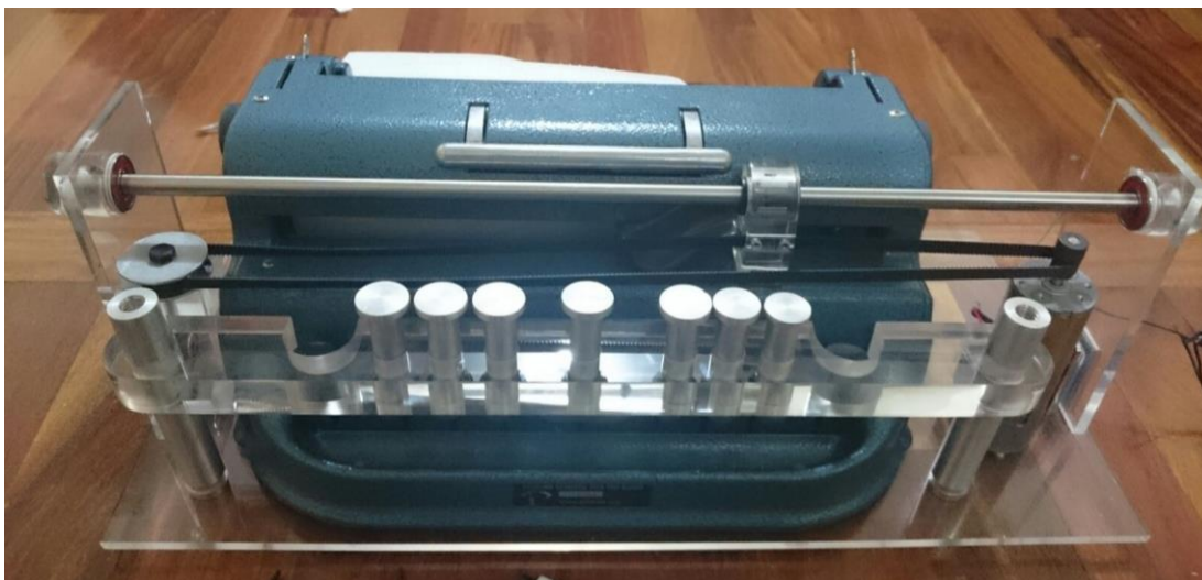
Figura 60: Colocación de la pieza de acrílico intermedia
