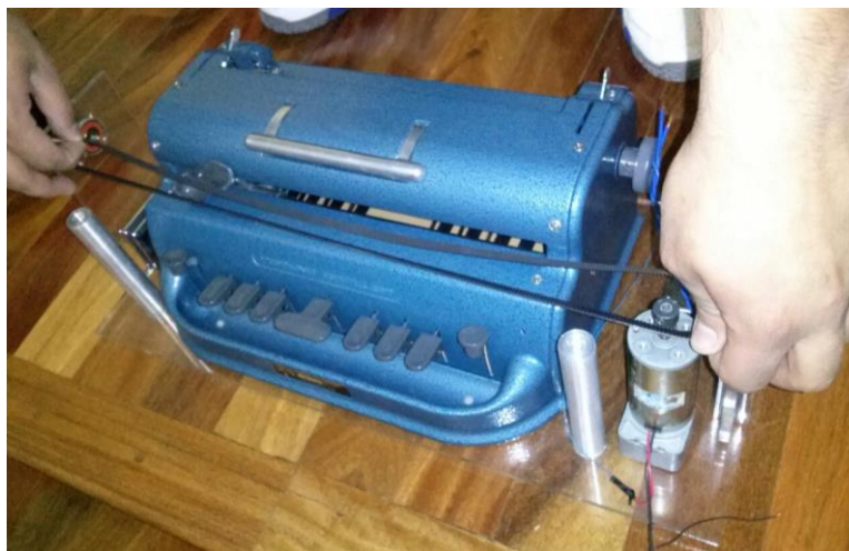
Figura 57: Verificación de la longitud de la banda de transmisión
