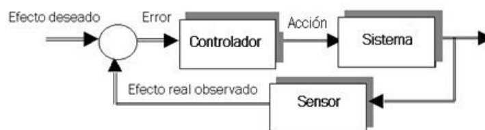
Figura 41: Sistema de control en lazo cerrado 24
