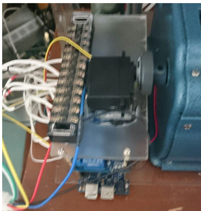
Figura 65: Acople del servomotor al tambor de la máquina de escribir
