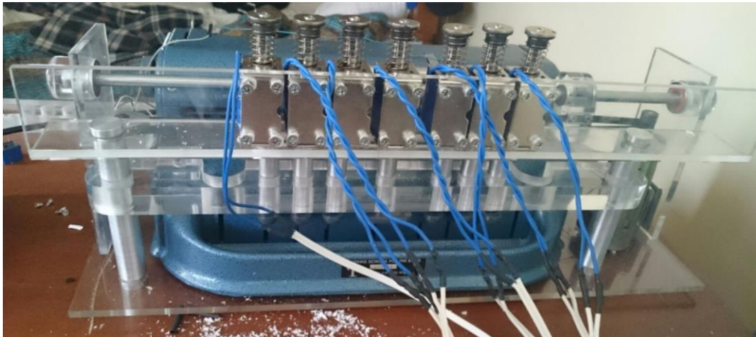
Figura 62: Acople de la placa superior y los actuadores a la estructura
