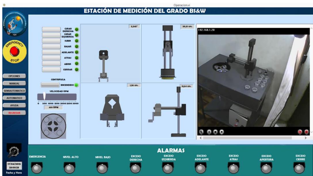
Figura 65 Integración del Sistema de Monitoreo al HMI
