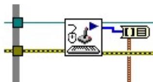
Figura 59 Función para tomar los datos del teclado del ordenador
