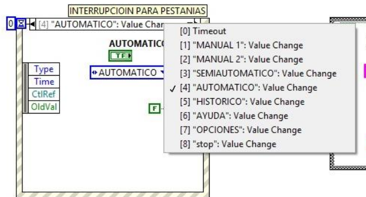
Figura 54 Interrupción usada para el cambio de pestañas
