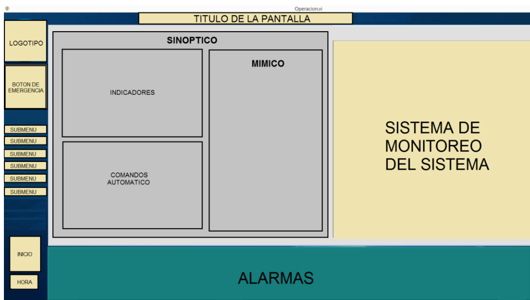
Figura 31 Diseño de la pantalla de modo automático
