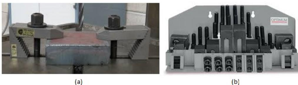
Figura 18: (a) Brida de sujeción, (b) Juego de bridas de sujeción
