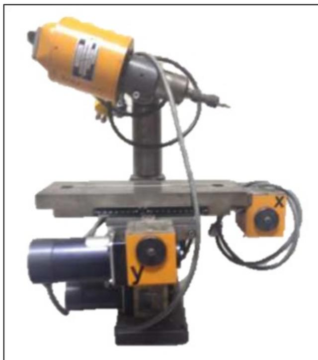
Figura 2: Taladro/fresador TERCO LA-20 del laboratorio
