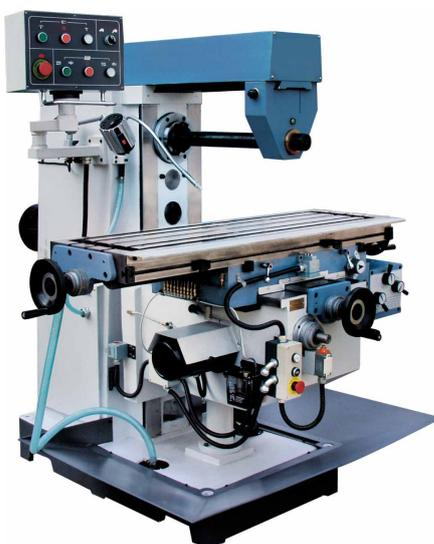
Figura 5: Fresadora horizontal
