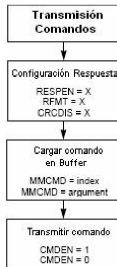
Figura. 3.7. Diagrama de Flujo para la Transmisión de Comandos.
