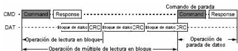
Figura 2.5. Operación de Lectura por Múltiple Bloque
