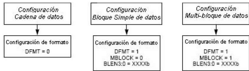
Figura. 3.9. Diagramas de Flujo para la Configuración del Controlador de Datos
