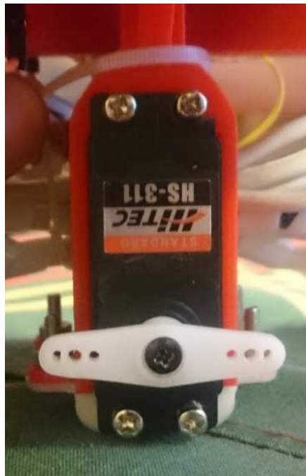
FIGURA No. 226: Servomotor colocado en la base
