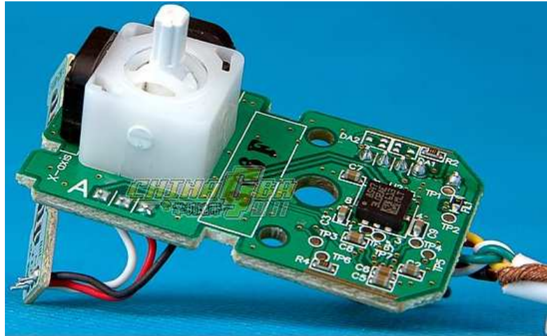
FIGURA No. 191: Botonera, potenciómetro y acelerómetro.
