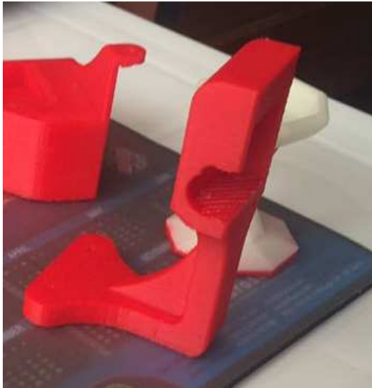
FIGURA No. 222: Mecanismo eje X e Y
