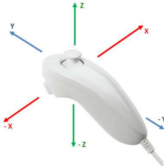
FIGURA No. 192: Ejes de referencia del acelerómetro.
