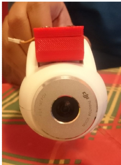
FIGURA No. 229: Ensamble de la cámara del drone
