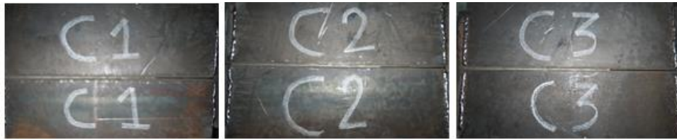
Figura 29 Identificación de cupones sometidos a soldadura con argón
