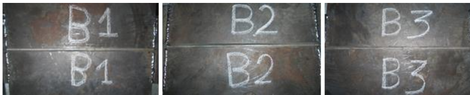
Figura 30 Identificación de cupones sometidos a soldadura con mezcla Argón – CO 2
