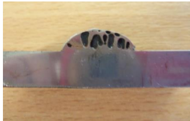
Figura 53 Porosidad presente en el cordón de soldadura
