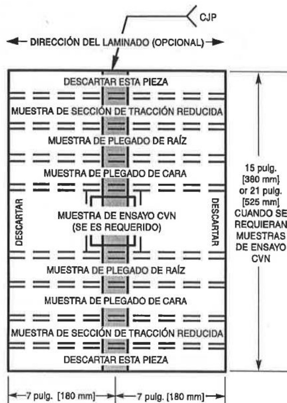
Figura 15 Cupón de prueba para espesores menores o iguales a 10 mm (Society(AWS), 2010)
