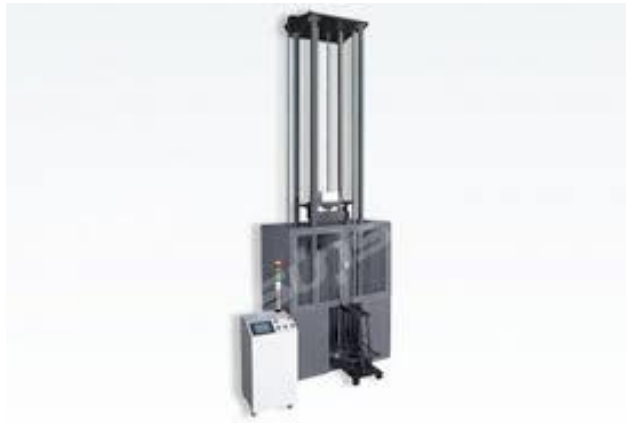
Figura 11 Máquina para realizar ensayo de impacto por caída de peso (Vaidya, 2002).
