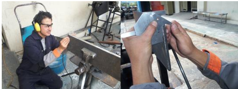
Figura 28 Control metrológico de la junta
