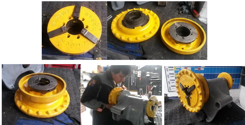
Figura 89. Ensamble de mandril frontal
