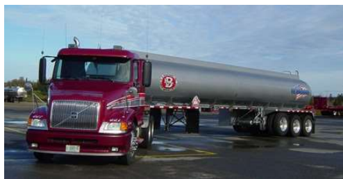
Figura 3: Autotanque de 10000 Galones
