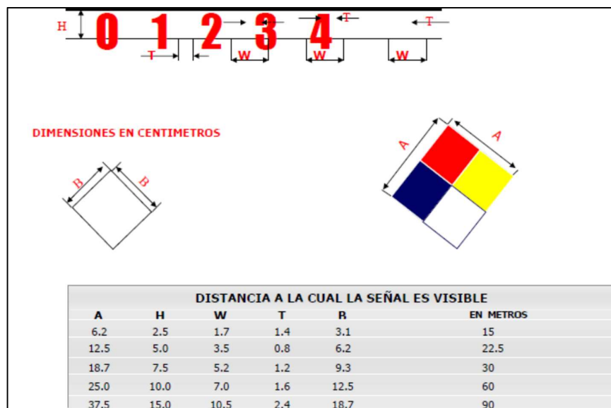
Figura 18: Dimensiones del rombo y de los dígitos empleados en el diamante de fuego.
