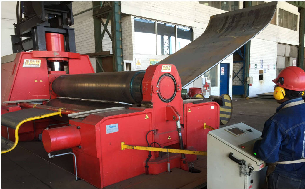
Fotografía 3 Rolado de Plancha de Acero A-36
