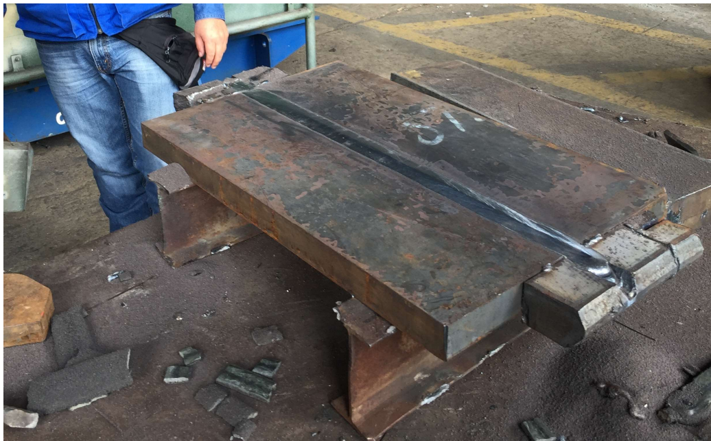
Fotografía 2 Calificación de Soldadura
