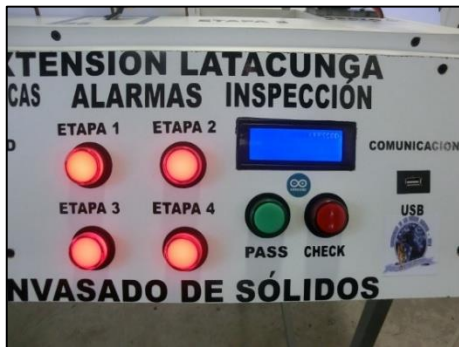
Figura 26: Accionamiento de las alarmas del módulo didáctico
