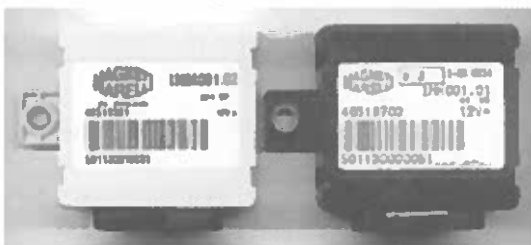
Fig.10. Módulo del Inmovilizador independiente del PCM
