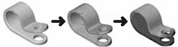
Fig 6. Secuencia del proceso de análisis en COSMOSWorks
