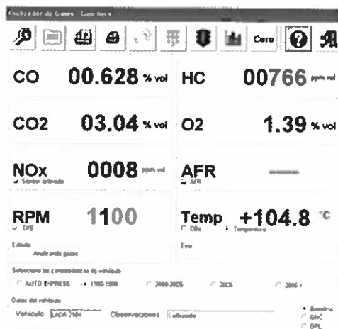
Fig. 9 Análisis de gases (convencional)
